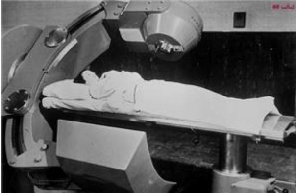
a. دستگاه کبالت ۶۰ : همانطور که از نامش مشخص است، این دستگاه از چشمه کبالت ۶۰ به عنوان منبع پرتویی استفاده می کند. کبالت ۶۰، پرتوی گامایی با انرژی میانگین  $MeV 1.25$  ساعت می کند. بین مواد رادیواکتیو، کبالت بهترین و مناسب ترین ماده رادیواکتیو برای پرتودرمانی خارجی است. از این پرتوهای  $\gamma$  در درمان استفاده می شود و می توان تومورهای عمقی را با آن درمان کرد.
